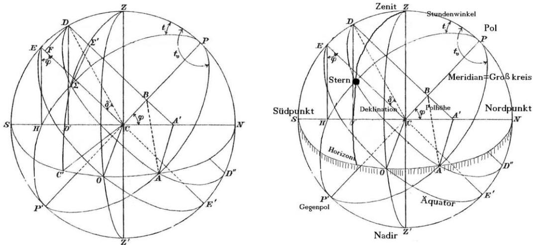
In dieser Abbildung 6-6 erkennen wir zwei Winkel, die in der Astronomie eine wichtige Rolle spielen:  $\sphericalangle DCE = * = \text{Deklination} = \text{Abweichung}$  und  $\sphericalangle PCN = v = \text{Polhöhe}$ . An Hand dieser beiden Winkel lässt sich die prosthaphäretische Formel herleiten, wenn man die Kugeldarstellung auf den Meridian SZN orthogonal projiziert, eine Methode, der sich schon die Araber bei ihren astronomischen Untersuchungen bedient haben, siehe Abbildung 6-7.
